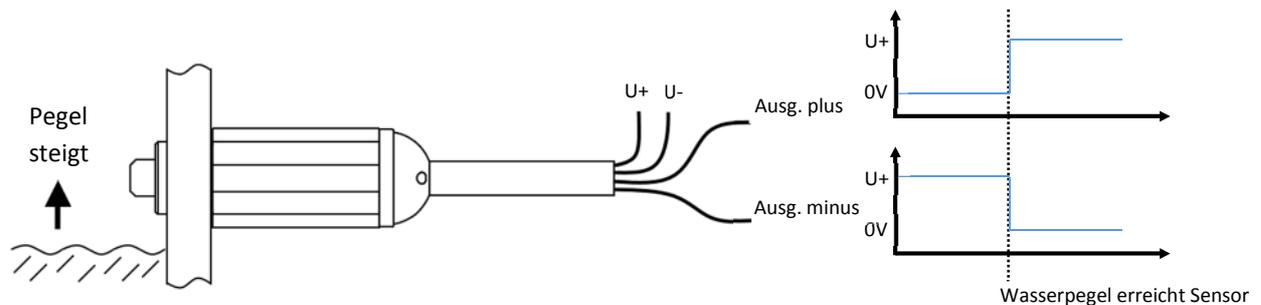
Über eine geeignete Verschaltung können die Ausgangsleitungen sowohl über eine Bordelektronik ausgewertet als auch über LEDs visualisiert werden.
