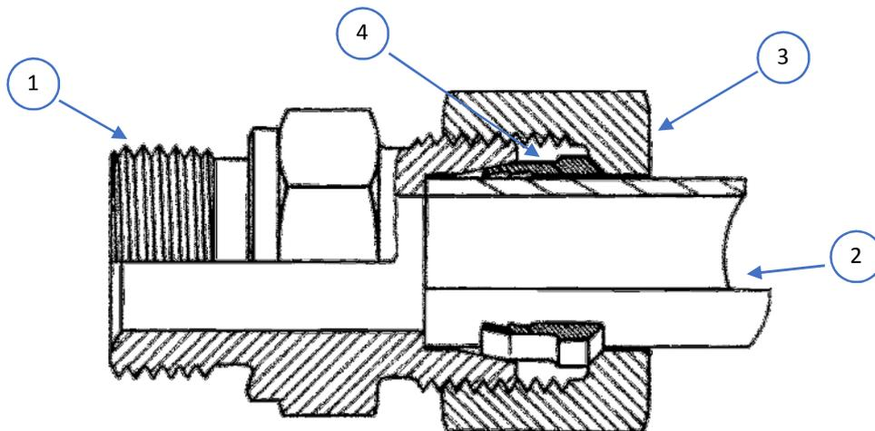
1. Verschraubung in den Separ-Filter schrauben. Die Abdichtung übernimmt ein vormontierter O-Ring.
