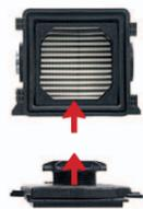
Setzen Sie den Deckel auf das Gehäuse.
