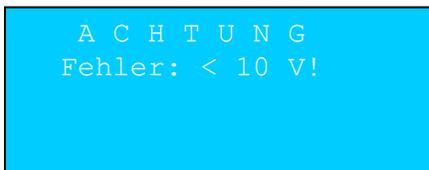
Die Fehlermeldung wird durch Anschluss der korrekten Betriebsspannung gelöscht.
