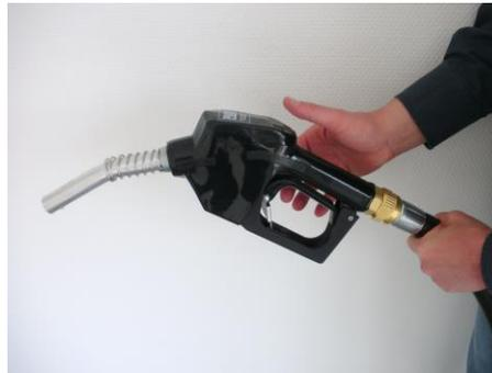
Verriegelungshebel einrasten. Zapfpistole ist jetzt geöffnet.
