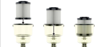
11 Komplettiertes Filterelement in den Container einsetzen.
