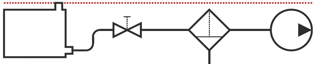
Wenn der Zulauf des Filters oberhalb des maximalen Füllstands im Tank liegt, ist ein Sperrventil zwischen Tank und Filter nicht zwingend erforderlich.
