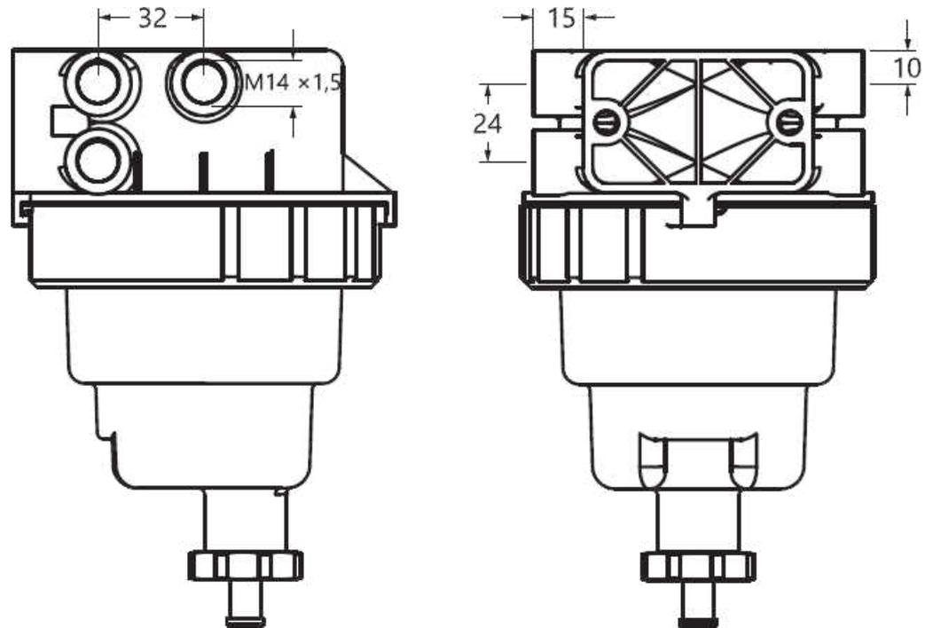
M14×1,5: Torque 14 Nm ±1 Nm
