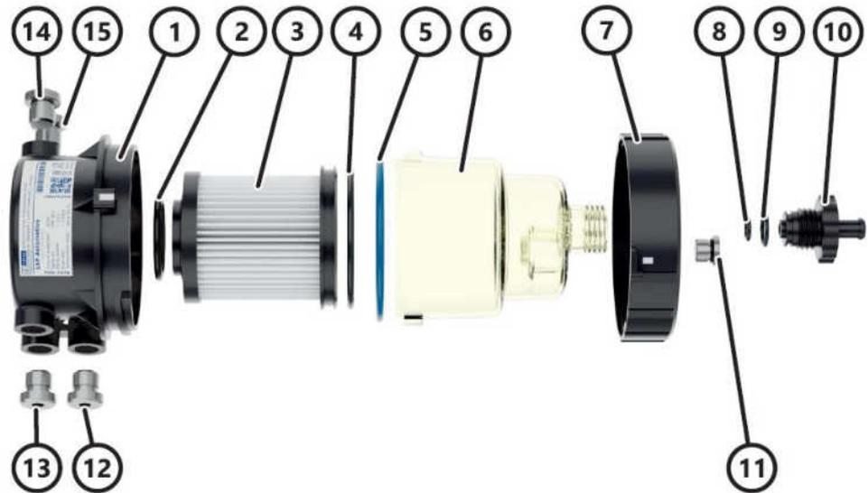
Abbildung 18: Einzelteile des Filters
